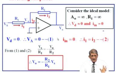
Basic Op amp Circuits Inverting Amplifier
