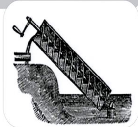
Archimedes (~ 250 BC) Archimedian Screw
